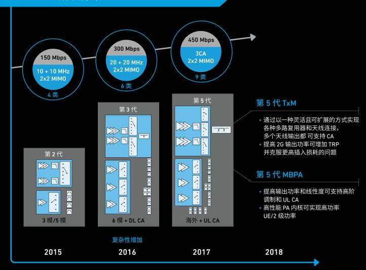
每次推出的新一代 RF Flex 都可提供 OEM 要求的更高性能和能力,以满足不断变化的市场需求。通过实施新技术,Qorvo 的最新一代 RF Flex (第 5 代) 继续向这个趋势推进,以支持 3+ 下行链路,并选择上行链路载波聚合用例。第 5 代为 OEM 带来了即可满足全球市场需求又可针对地区市场进行优化的解决方案。
